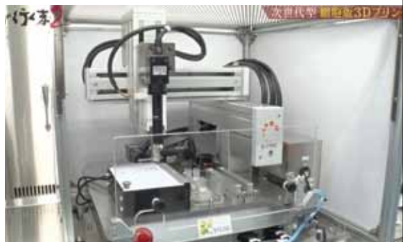
ニーズに合わせた臓器や組織が作れる、新型バイオ3Dプリンタ「S-PIKE」(スパイク)
