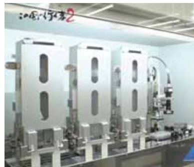
プログラム通りの形で、細胞が剣山に自動で積み上がっていくバイオ3Dプリンタ「Regenova」(レジェノバ)。
