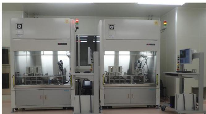
J-TEC のクリーンルーム内に設置した臨床用バイオ3Dプリンタ (澁谷工業とサイフューズの共同開発)
